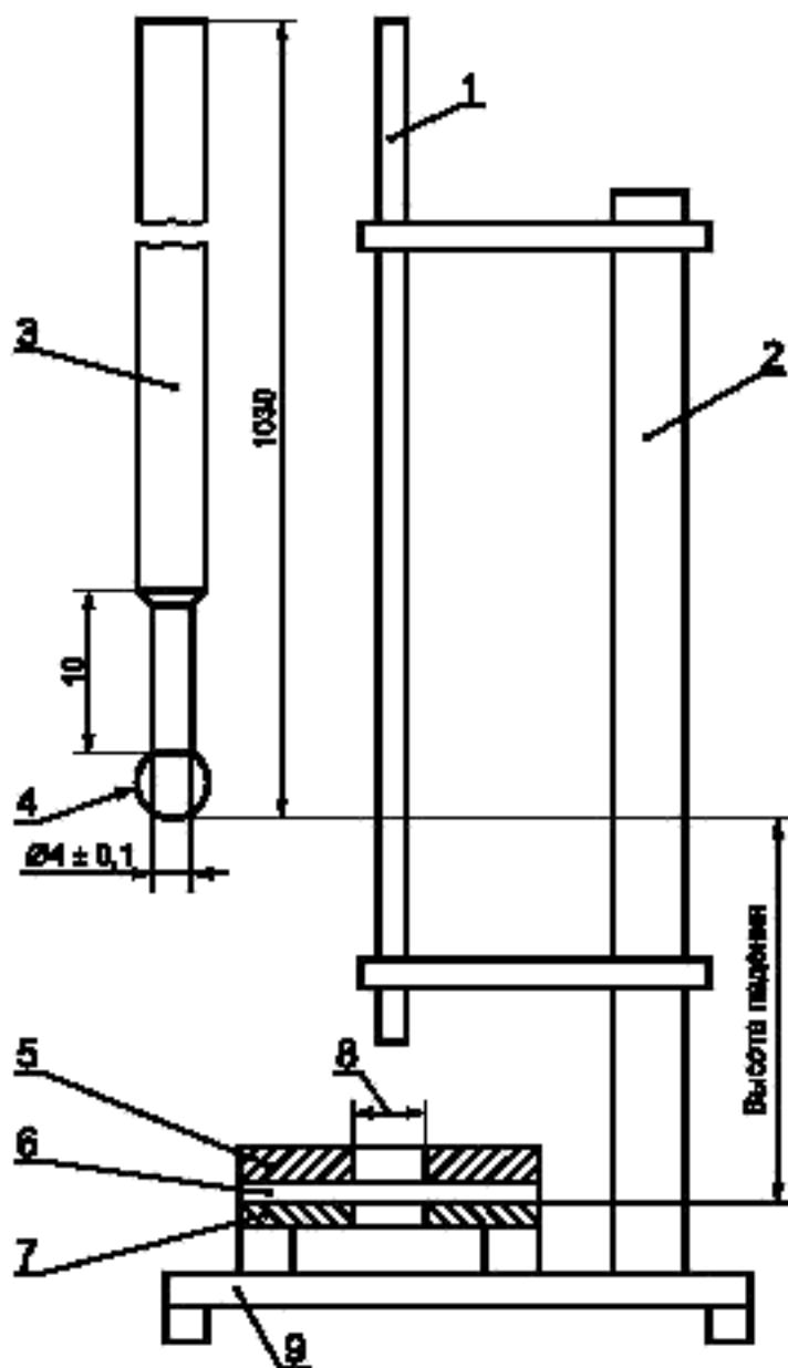
1 — вертикальная направляющая трубка; 2 — опорная трубка;
