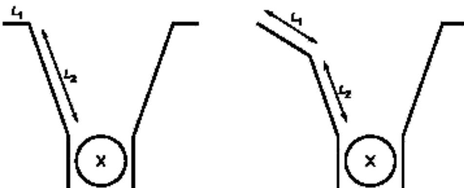
Рисунок 1 — Порядок измерений безопасного расстояния
